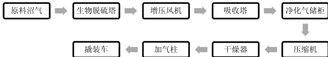
图 1 公司生物天然气提纯工艺流程图
